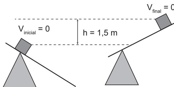
Seja uma rampa móvel que é levantada ao mesmo tempo em que um corpo de massa  $2,0 \text{ kg}$  se move sobre ela. Na figura, estão mostrados os instantes inicial e final da trajetória. Dado que as velocidades inicial e final do corpo são nulas e que  $h = 1,5 \text{ m}$ , calcule, em joules, o trabalho realizado pela rampa sobre o corpo.
