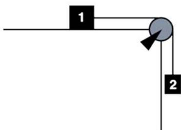
Seja o sistema mostrado na figura. A caixa 2, de massa  $m_2 = 2,0 \text{ kg}$ , está descendo com velocidade constante e igual a  $1,5 \text{ m/s}$ . O coeficiente de atrito cinético entre a caixa 1 e a mesa que a sustenta é  $0,4$ .
