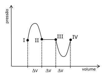
O processo 1 tem estado inicial I e final II, o processo 2 tem estado inicial II e final III, e o processo 3 tem estado inicial III e final IV.
