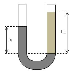
Considerando-se os fluidos imiscíveis entre si e denotando-se por g o módulo da aceleração da gravidade, a razão  $h_{\rm I}$  / $h_{\rm II}$  entre as alturas é dada por
